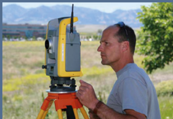
Съемка с электронным тахеометром Trimble.
